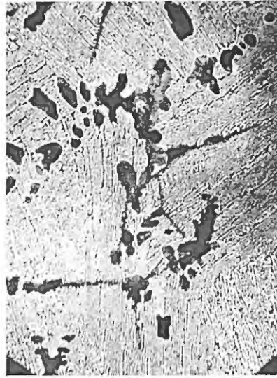
写真-6 過共晶Fe-C合金，共晶初期水冷 (×240)
