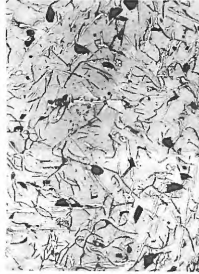
写真-8 Fe-C合金，850℃水冷 (×65)
