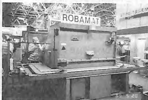
図11. ボックスの中で自動バリ取りを行う。製品はボックスの外を治具に乗って移動する。治具への乗せ換えは人手、3種類の製品を順次連続的に行う。
