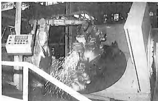
大型ポジショナー付システムの切断様子
