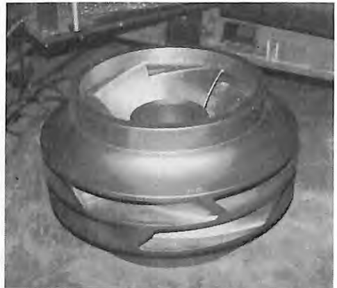
ダブルサクシオンインペラー（ショウプロセス鋳鋼品）材質SCS6 単重58kg
