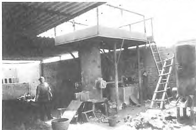
図3 中規模工場のキューポラ
