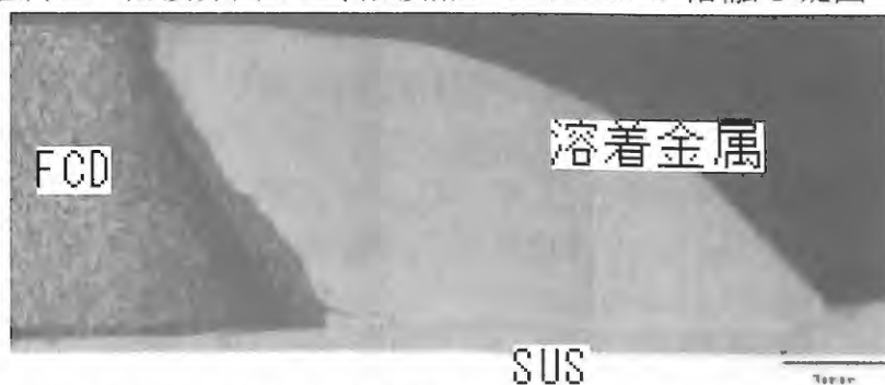
図1 溶接部断面写真 (ヒレラ腐食)
