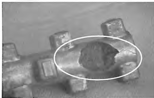
図2 湯口棒の欠落部
