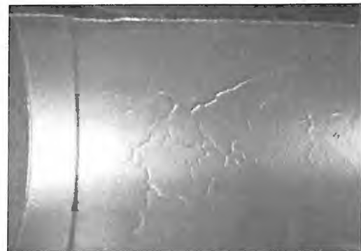
図5 再現実験による割れの状態
