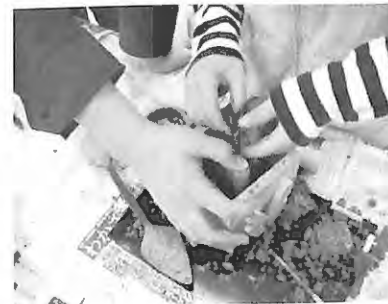
図4 上型(鑄枠)への砂入れ
