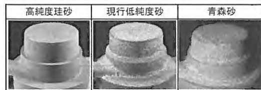
砂焼付性評価（鋳物表面観察） 鋳物組成比および耐火度
