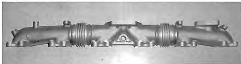
Fig. 1 ベローズ締結一体型マニホールド
