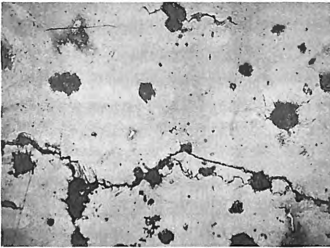
図16. 試料No.6 48.5 \text{ kg/mm}^2 2.9 \times 10^3 回 ( \times 270 )
