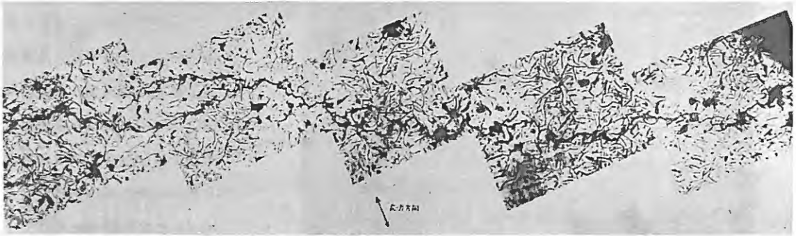
図17. 片状黒鉛鋳鉄の疲労破壊 ( \times 65 ) 8.3\text{kg}/\text{mm}^2 9.79 \times 10^6 回 2,100rpm
