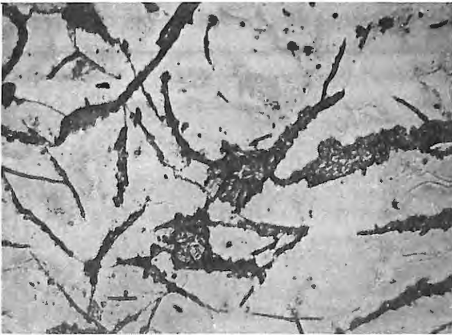
図 14. 試料 No. 3 11.6kg/mm 2 2.02×10 4 回 (×270)
