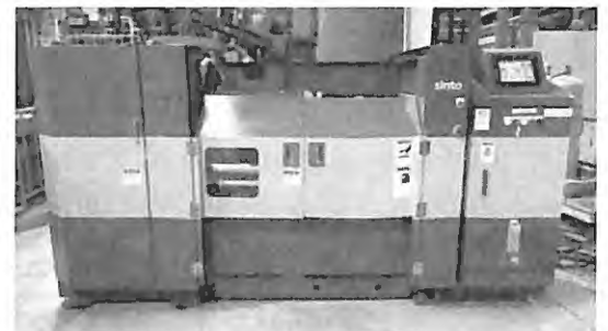
図6 新型中子造型機CDRXの外観
