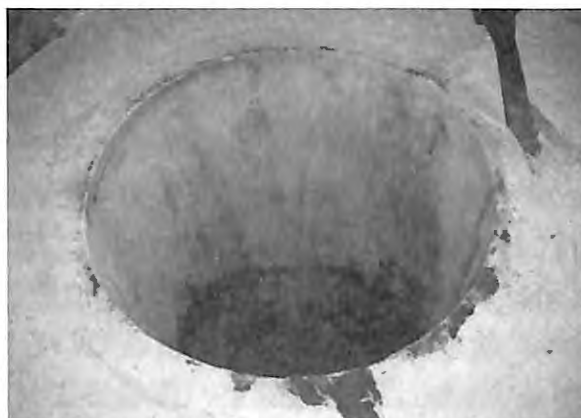
フォーマ抜いた後の炉材状態
