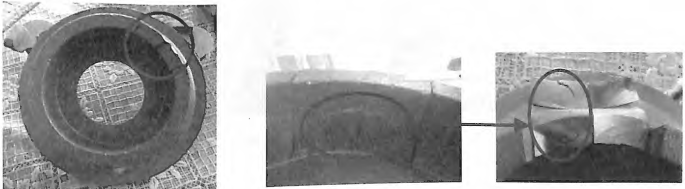
図1 センサー台全体図およびすくわれ不良発生箇所
