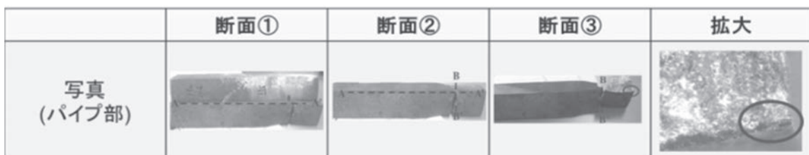
Fig. 3 破断面(パイプ部)
