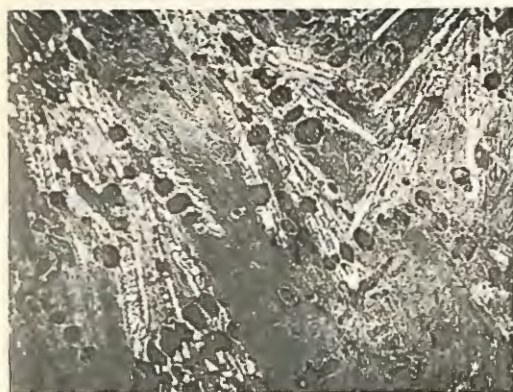
第21図 垂共晶 Fe-C-Mn (6%) 合金, 共晶初期水冷, ピクラル腐食 ×65
