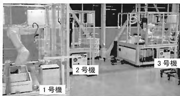
図5 ゲーティングロボット3台体制での生産
