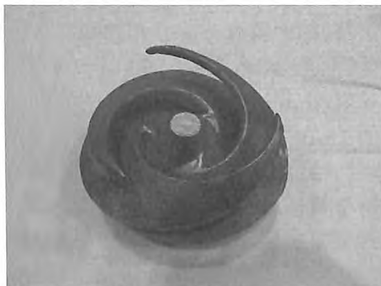
図15 試作した3枚羽根の羽根車
