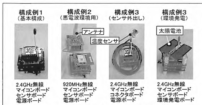
図 2 IoT 体験キットを用いた無線センサの構成例
