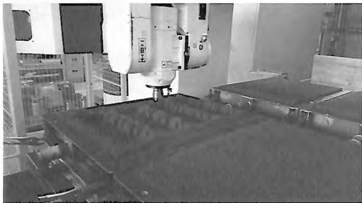
図1 5軸マシニングセンタによる切削鑄型の製造方法
