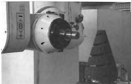
図14 5軸マシニングセンタによる中子加工の様子
